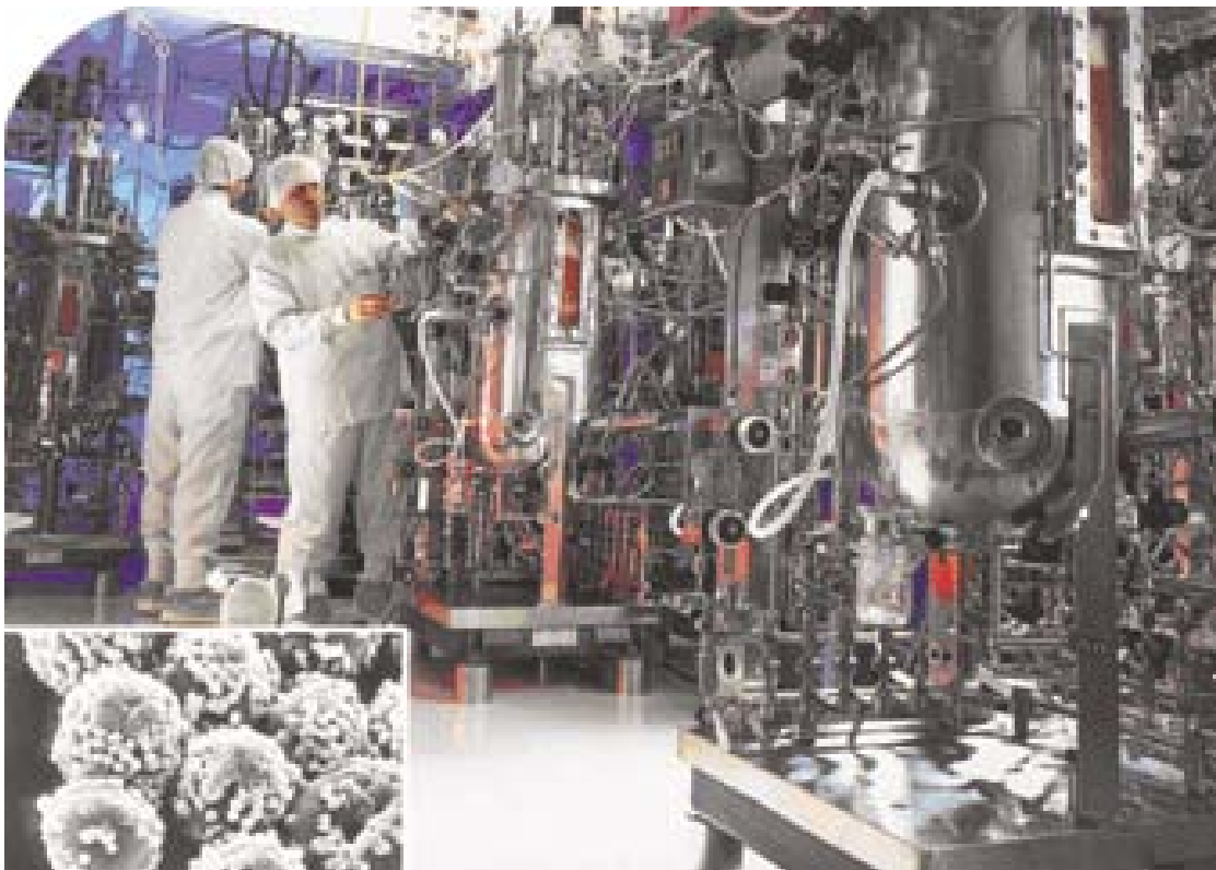
תמונה 2. ייצור רביף (אינטרפרון-בטא) במעבדות אינטרפרם (סרונו). תאי CHO המהונדסים גנטית הגדלים על נשאים (בתמונה הקטנה) מוכנסים לפרמנטורים ומפרישים את האינטרפרון למדיום.
